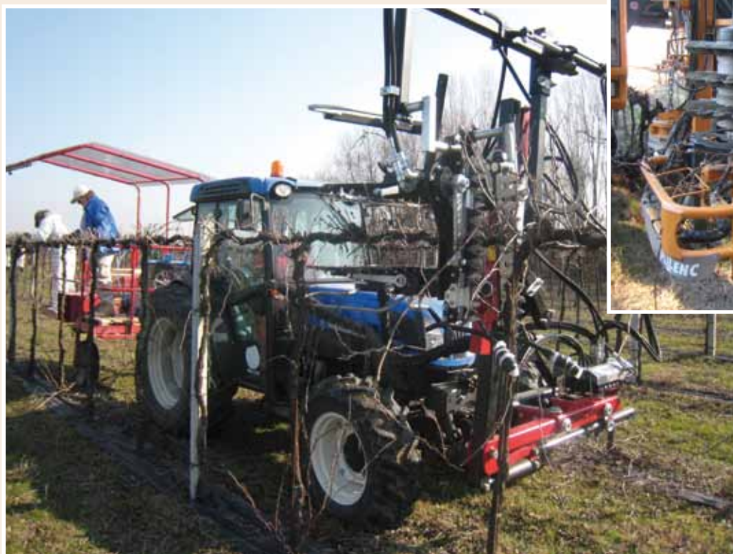
▲ Particolare degli organi di taglio di una potatrice impiegata per la potatura senza rifinitura manuale
