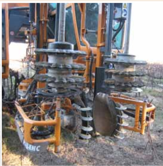
▲ Particolare degli organi di taglio di una potatrice impiegata per la potatura senza rifinitura manuale
